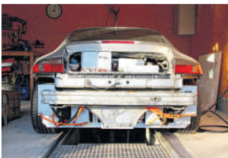
Die Heckansicht des 911ers: Die orangefarbenen Kabel verbinden die Batterieblöcke mit dem Motor im Kofferraum.
